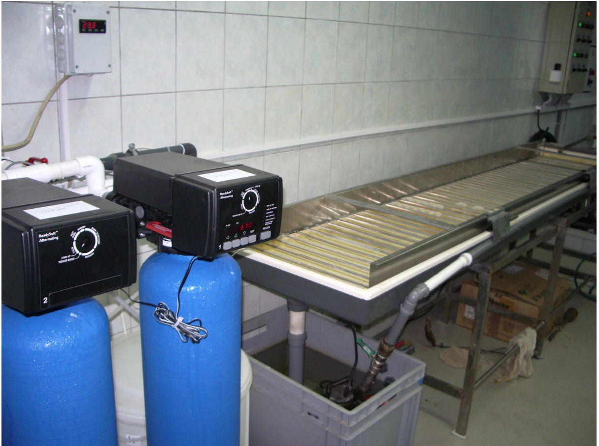
4 pav. Gruntinio apytakinio vandens suminkštavimo aparatai, prijungti prie suomių modelio vėžių kiaušinėlių inkubatoriaus (LVŽŽTC Simno eksperimentinis žuvų veislynas, 2008 m.) (R. Jakiūno nuotr.)
