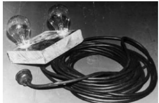
10 pav. Povandeninis šviestuvas varžoms apšviesti nakties metu
